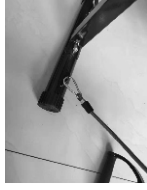
Krok 6: zainstaluj linkę pociągową na rurze podnóżka
